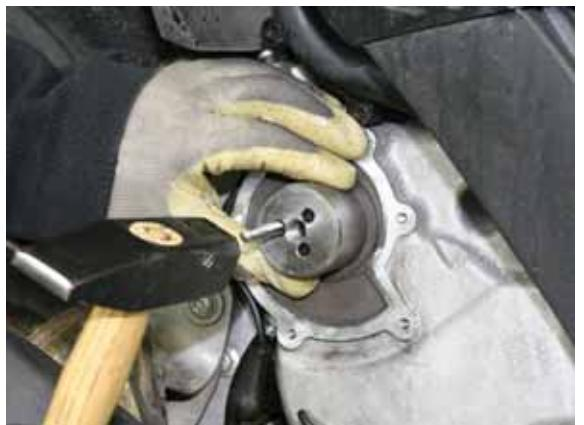
Den Abzieher mit der zum Werkzeug gehörenden Schraube am statischen Teil der Dichtung befestigen.
