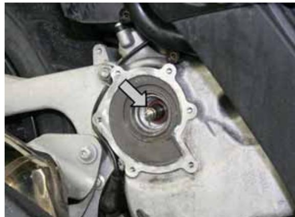
Montar la barra atornillándola en el eje del rodete.
