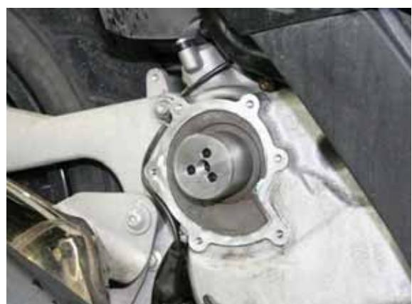
Completar la herramienta instalando el estribo, el tornillo y la tuerca.
