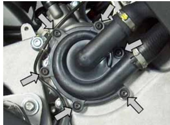
Mit einem 8mm-Schlüssel das Laufrad der Wasserpumpe abschrauben.
