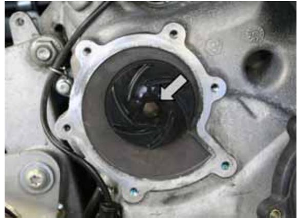
Utilizzare due cacciaviti a lama piatta , posizionati come in figura in modo da poter forzare sul bordo del carter evidenziato e scomporre la tenuta integrale, montata forzata sull'albero della girante.
