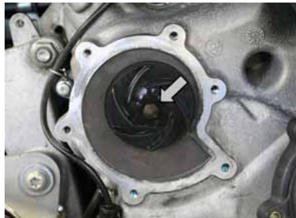
Utilizar duas chaves de fenda com lâmina plana, posicionadas como indicado na figura para poder forçar na borda do cárter evidenciado e desmontar a estanqueidade integral, montada obrigatoriamente no veio da girante.
