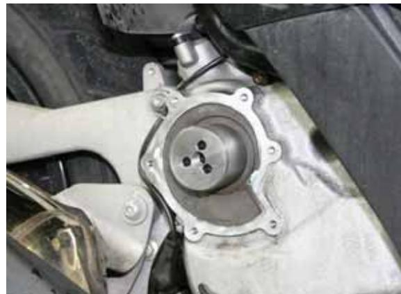
Completar a ferramenta instalando a haste, o parafuso e a porca.
