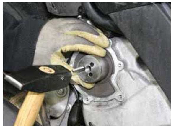
Fixer l'extracteur à la partie statique du joint d'étanchéité en utilisant les vis fournies avec l'outil.
