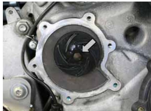
Zwei Flachkopfschraubenzieher verwenden. Wie in der Abbildung gezeigt am Rand des Gehäuses ansetzen, heben und die Integraldichtung, die auf die Laufradwelle aufgepresst ist, zerlegen.
