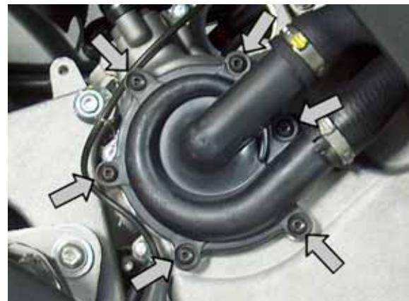
Dévisser la roue de la pompe à eau à l'aide d'une clé de 8 mm.
