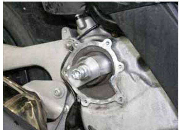
Mantenere fissa la vite ed azionare il dado fino ad ottenere la completa estrazione della parte statica della tenuta.
