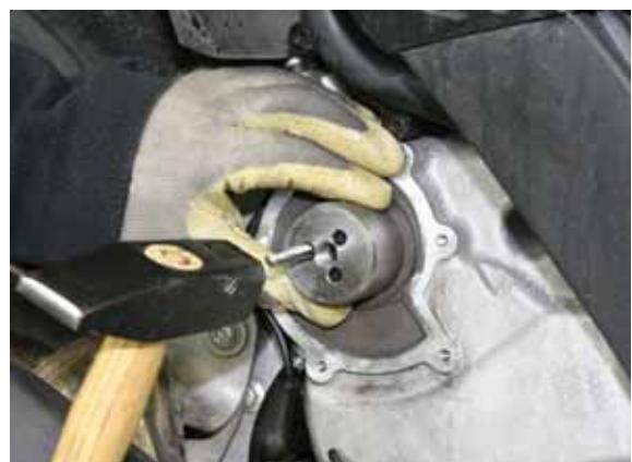
Fijar el extractor en la parte estática de la junta de estanqueidad, utilizando los tornillos provistos con la herramienta.
