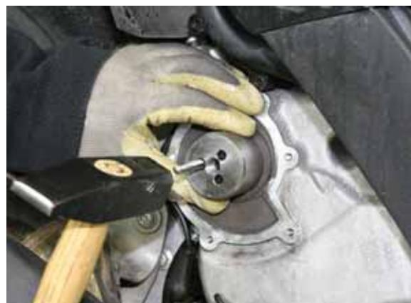
Fixar o extractor na parte estática da estanqueidade, utilizando os parafusos fornecidos com a ferramenta.
