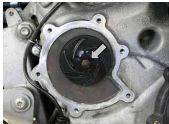
Montar a tampa da bomba utilizando uma nova guarnição, precedentemente lubrificada com massa lubrificante de vaselina.
