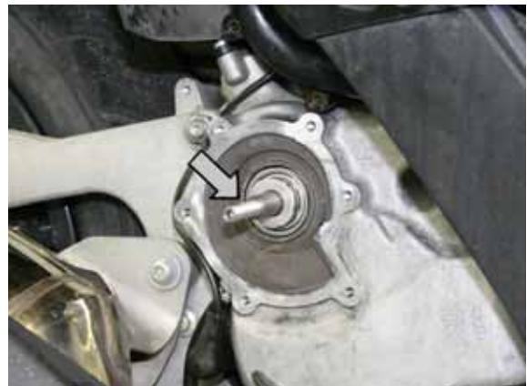
Τοποθετήστε το ζουμπά (ρυθμιζόμενου ύψους).
