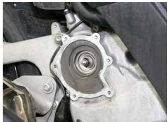
Situar el extractor con la clavija en la parte estática de la junta cerámica.
