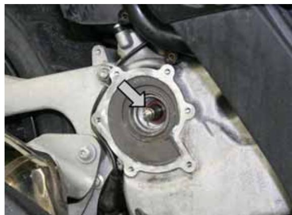
Monter la barre en la vissant sur l'arbre de la roue.
