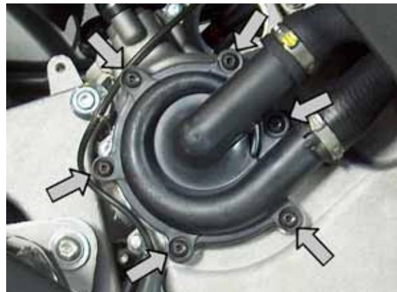
Mediante uma chave de 8 mm, afrouxar a girante da bomba d'água.
